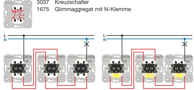
**Bild 1:** Kreuzschaltung / Kreuzschaltung beleuchtet: Glimmaggregat leuchtet bei „Aus“
